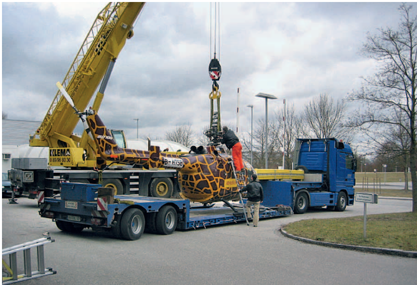
Die WeiLa-Tieflader können bis auf wenige Zentimeter Bodenfreiheit abgesenkt, aber auch deutlich erhöht werden, um beispielsweise über Verkehrsinseln zu fahren.
